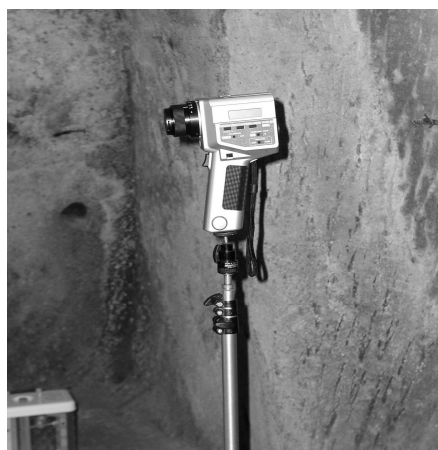
Figura 4: Luminanzometro in prossimità di una parete all'interna alla cavità.
