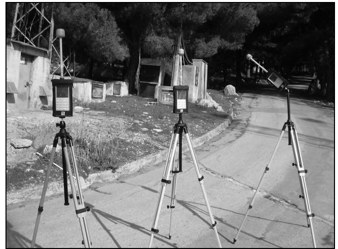
Figura 6: Misura statica di campo elettrico
