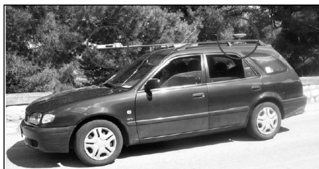
Figura 1: Mezzo mobile di misura dei campi elettromagnetici
