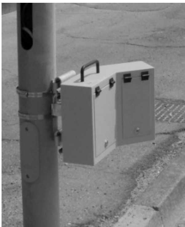
Figura 3 – Rilevatore flussi traffico
