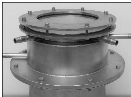
Figura 5: Reattore sonofotolitico realizzato.
