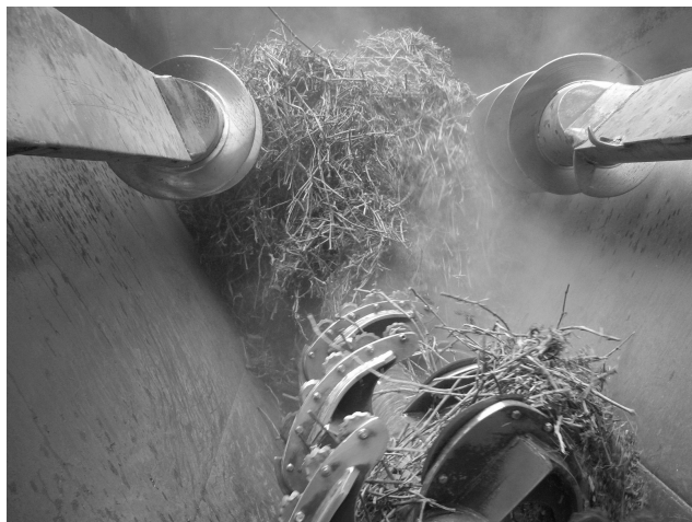
Figura 7: Vista interna del carro miscelatore
